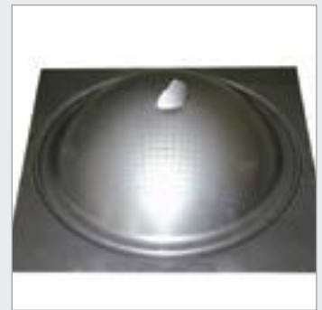
液压胀形 Hydraulic Bulge Test
